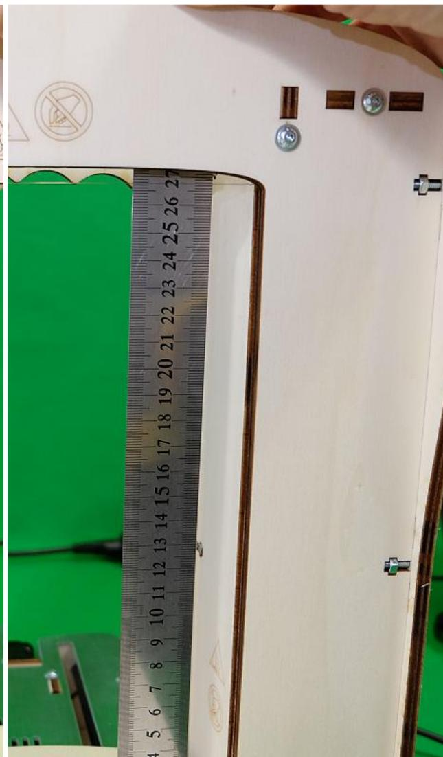
S'il y a une correction à faire, dégager légèrement le fil vers le bas en tournant les tiges filetées à la main.
