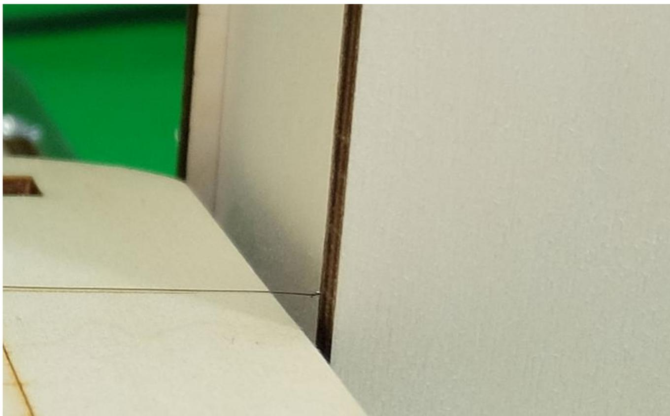
Refaire la procédure pour l'interrupteur DB : mouvement vers le bas jusqu'à l'arrêt, puis réglage de l'interrupteur pour avoir le fil au ras du plateau du côté de DB.
