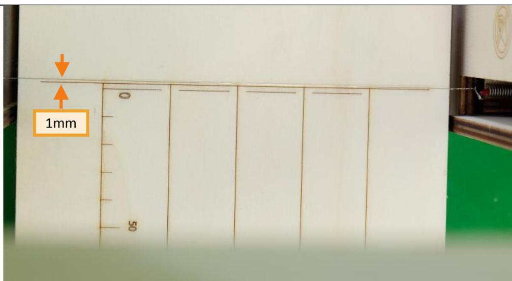
Reculer légèrement le plateau en tournant la tige filetée à la main (par l'extrémité qui dépasse du châssis de la MiniCut2d).
